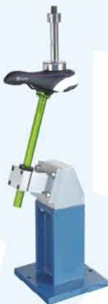
DBG008-A 車架 水平疲勞測試 (第三缸)
