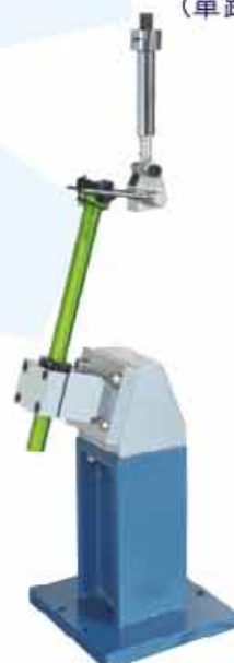
DBG009-B 傳動曲柄 強度疲勞測試 (單踏力)
