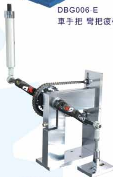
DBG009-B 傳動曲柄 強度疲勞測試 (單踏力)
