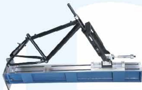
DBG008-A 車架 水平疲勞測試 (第三缸)
