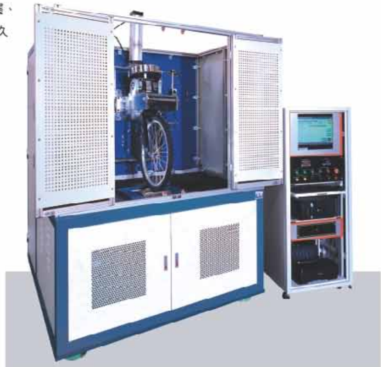
HT-2910 輪圈綜合試驗機
