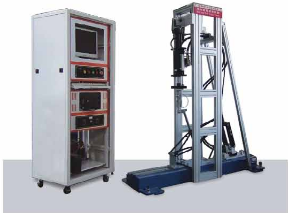
HT-2707SS 車架座管垂直疲勞試驗機
