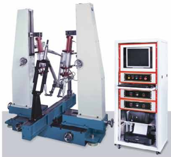
HT-2331A 自行車動態疲勞試驗機
