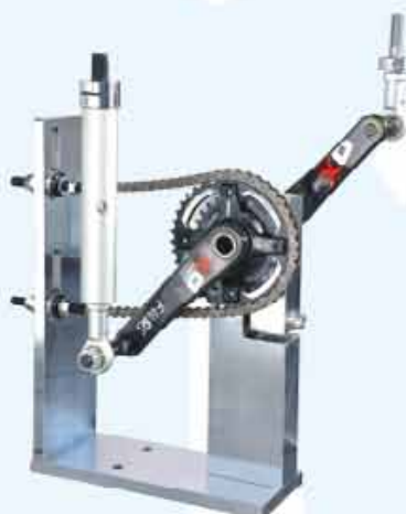
DBG009-A 傳動齒盤 強度疲勞測試 (雙踏力)
