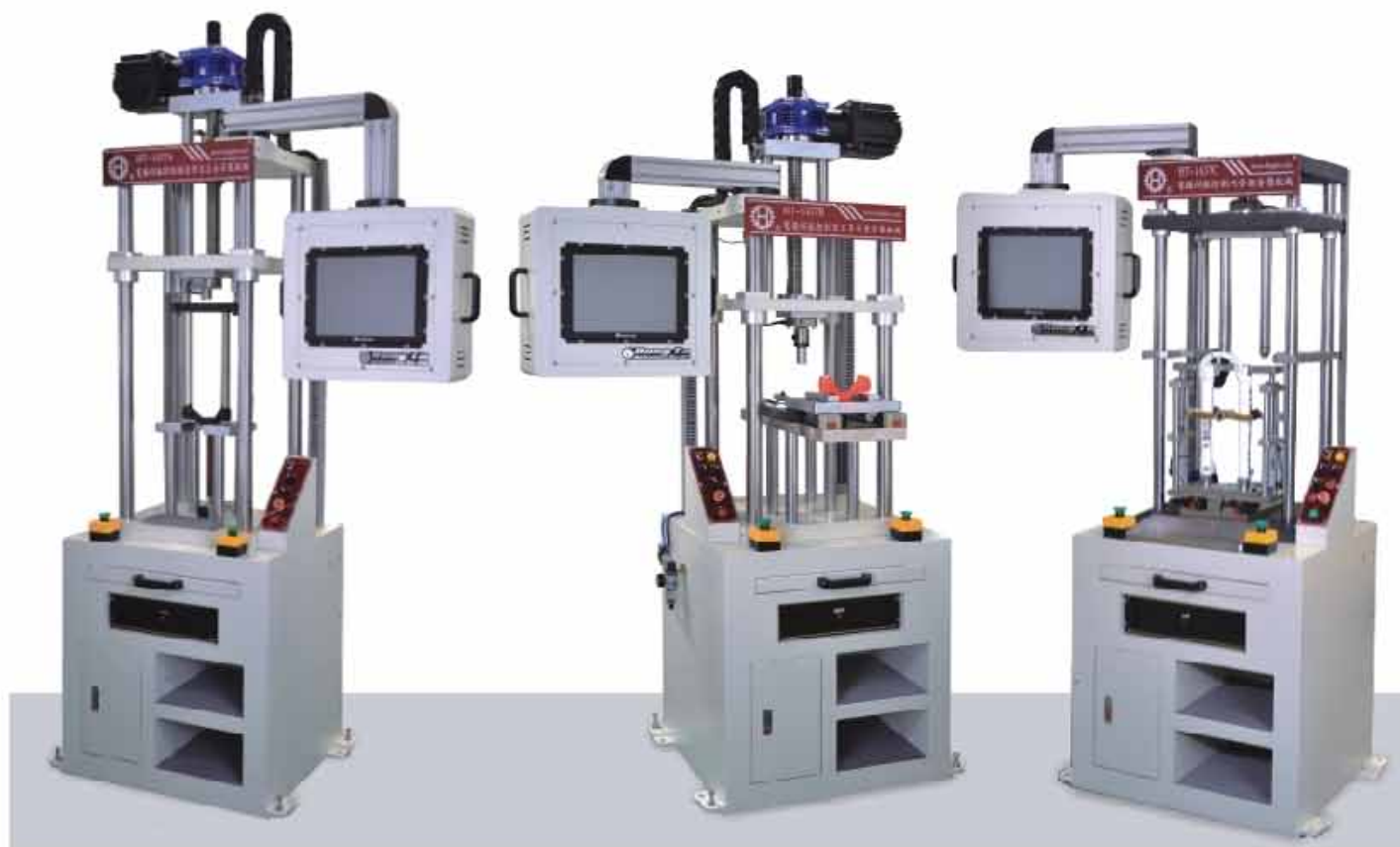
HT-1437A 電腦伺服控制 頭管座 & 內管壓配機
