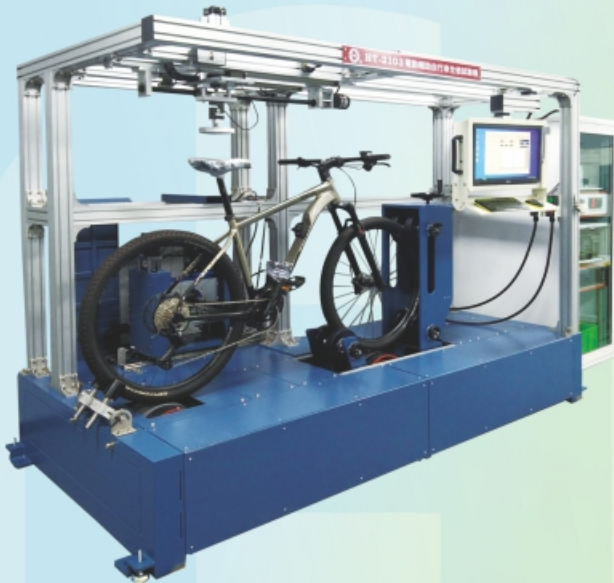
HT-2103 電動輔助自行車功率管理試驗機
